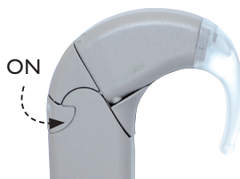
Obr. 4 Audio procesor OPUS 2 v poloze ON (Zapnuto)
