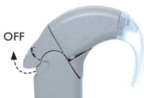
Obr. 3 Audio procesor OPUS 2 v poloze OFF (Vypnuto)
