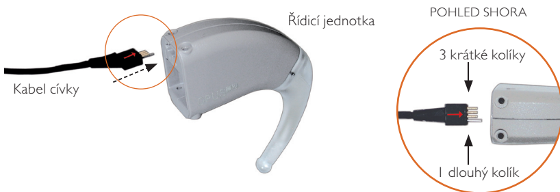
Obr. 13 Připojování kabelu cívky
